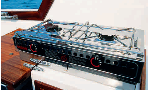
Pantry Der zweiflämmige Origo-Spirituskocher ist platzsparend unter dem klappbaren Beifahrersitz positioniert.
