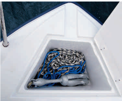
SBM Ihr Ankerkasten ist selbstlenzend und hat eine passende Größe.
