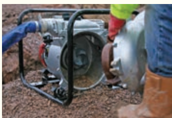
Der abnehmbare Inspektionsdeckel ermöglicht einen leichten Zugang
